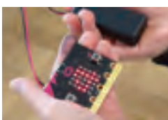
実践例(6) 照度計として使うマイクロビット
